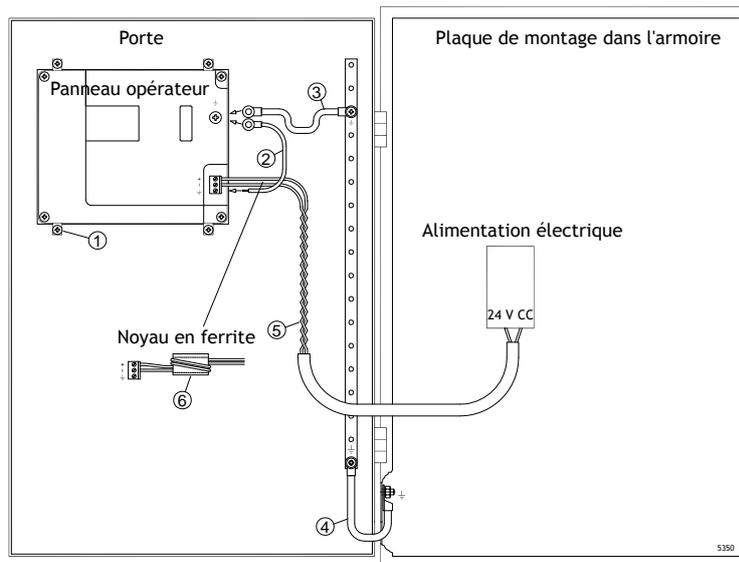
Les brides de fixation de panneau opérateur ne fournissent pas une connexion de mise à la terre sécurisée entre le panneau et l'armoire de l'appareil, voir 1 dans le schéma ci-dessus.
