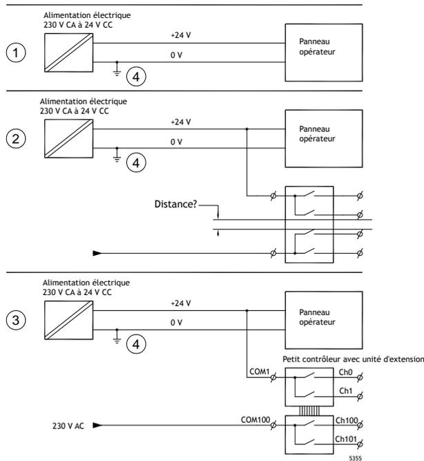
Si l'alimentation électrique utilisée est conforme aux normes de sécurité et n'alimente que le panneau opérateur, il n'y a pas de problème. Voir le point 1 sur le schéma ci-dessus.
