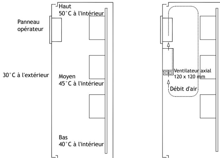
Dans la plupart des cas, la température ambiante pour le panneau opérateur est significativement plus élevée que celle du boîtier du périphérique.
