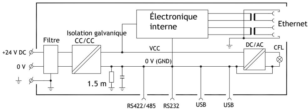
Le panneau opératoire possède une isolation galvanique contre l'alimentation 24 V CC mais pas entre les ports de communication pour RS232, RS422/485 et USB. Seule la connexion Ethernet possède une isolation galvanique.
