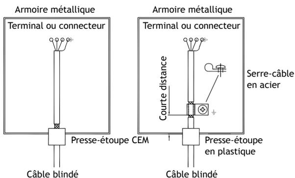
1. Utilisez un presse-étoupe CEM ou un presse-étoupe ordinaire en plastique, retirez la gaine extérieure et connectez le blindage à la plaque d'installation avec un serre-câble métallique de 360°.
