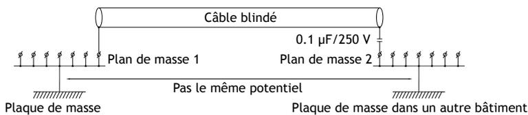
En cas de distances plus longues, le potentiel de masse risque d'être différent. Dans ce cas, le blindage doit être connecté uniquement à une extrémité. Une bonne solution consiste à connecter l'autre extrémité du blindage à la masse par l'intermédiaire d'un condensateur plastique 0,1 µF/250 V. Les deux extrémités sont ensuite reliées à la masse en termes de HF, mais seulement connectées à la masse à une extrémité en termes de LF, évitant ainsi les boucles de mise à la masse de 50/60 Hz.
