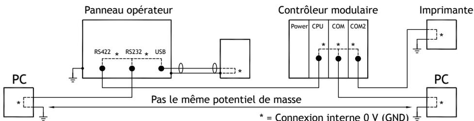
Quand un PC est connecté au panneau opératoire, la tension interne de 0 V (GND) du panneau est connectée à la terre de protection via le PC.
